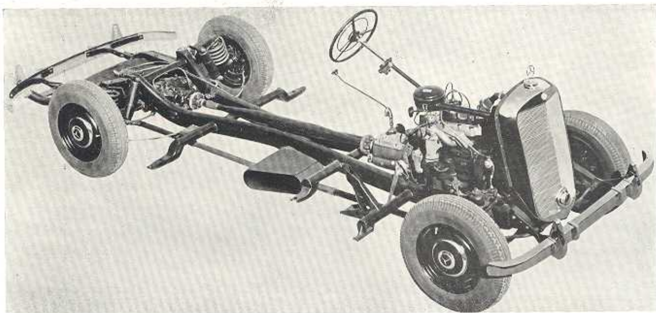
Das Fahrgestell des Typs 170 S — X-förmiger Rahmen aus Stahlrohr.
