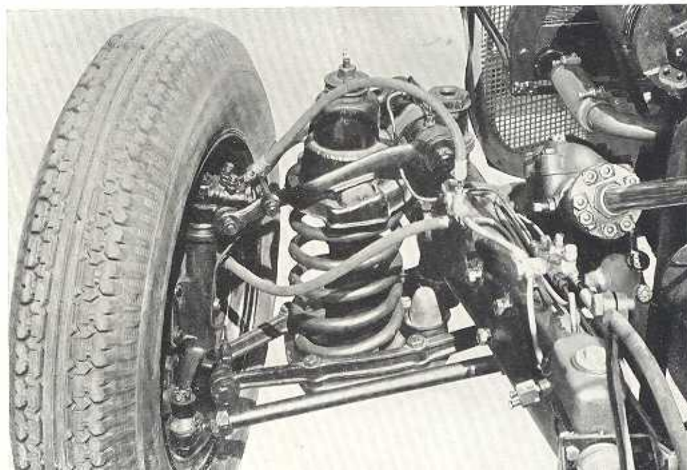
Die ideale Aufhängung der Vorderräder, Dreiecklenker, Schraubenfeder, Teleskop-Stoßdämpfer.
