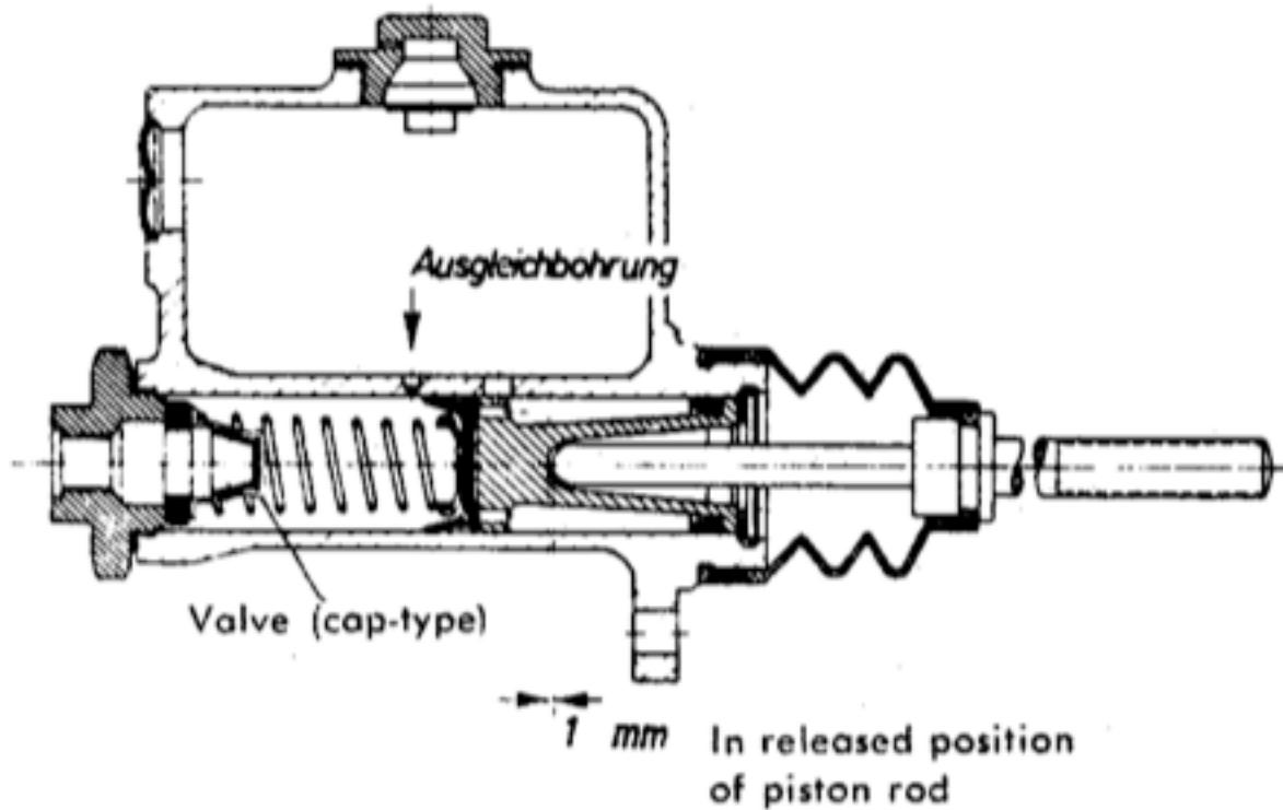
Ausgleichbohrung — Compensation bore
